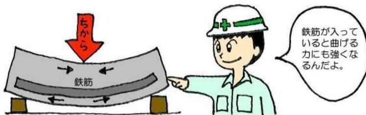
鉄筋コンクリートは、必要な曲げ強度を確保しつつ、製品を軽く、効率良い構造とするためにコンクリートを鉄筋で補強したものだよ。コンクリートは、圧縮力(押しつぶそうとする
