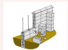
**コン太さん**：建築用製品類で2番目に説明する製品は、**軽量気泡コンクリートパネル(ALCパネル)**だよ。ALCパネルは、建築用の外壁や間仕切壁、床及び屋根材として使用されていて、水に浮くALCパネルもあるよ。
