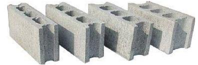
空洞ブロックは、主に建築用途に用いられるブロックで、本体に空洞をもつものが多いよ。つくり方は、パサパサの硬練りコンクリートを使って、成形後すぐに型枠(金型)から抜き取る即時脱型方式が多いんだ。(即時脱型方式については、「3. コンクリート製品の製造」のステップを参照してね。)
