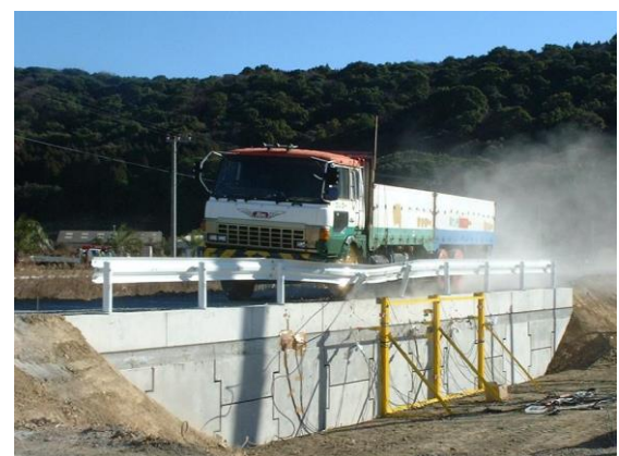
補強土壁擁壁工天端設置時の実車衝突試験 H=500
