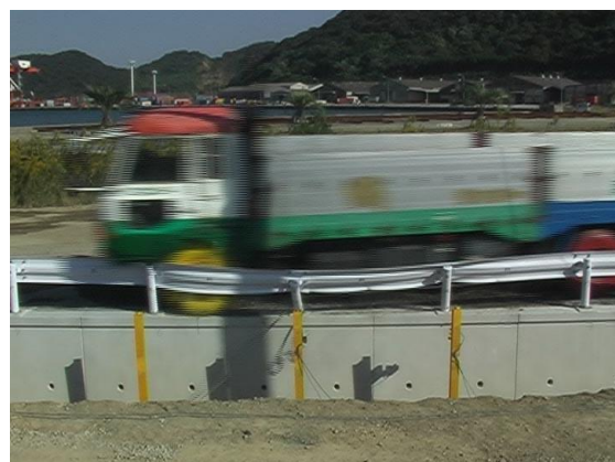
直接基礎設置時の実車衝突試験 H=1500
