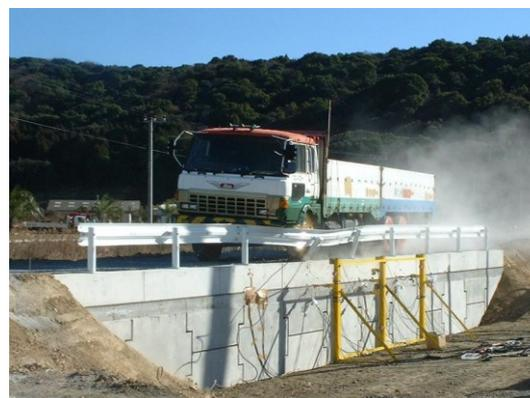
補強土壁擁壁上天端設置時の実車衝突試験 H=500
