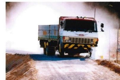
トラック衝突時 (補強土壁上)
