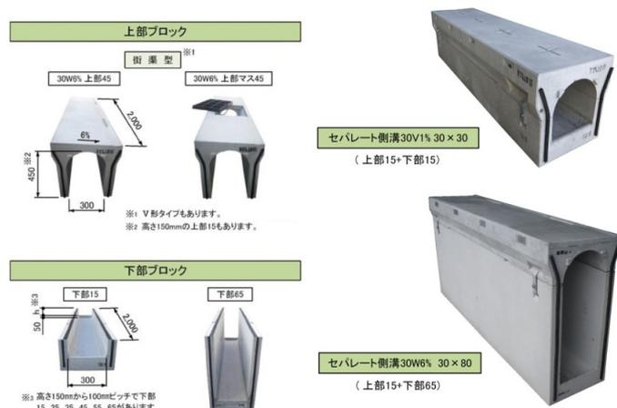
セパレート側溝 (製品写真)
